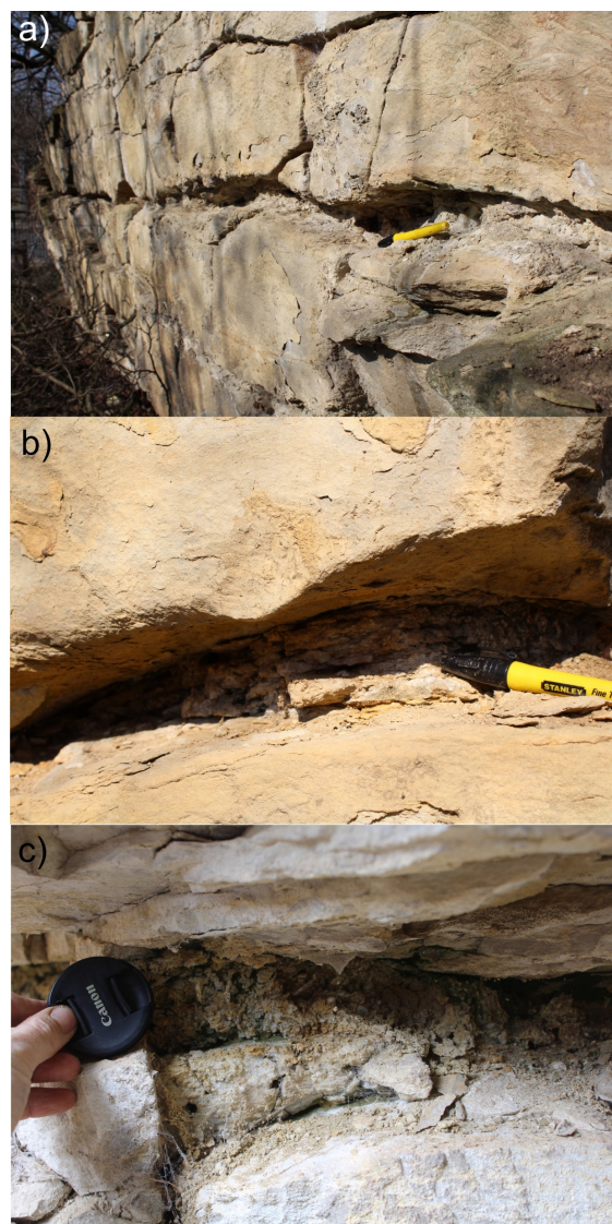
Obr. 17) Příklady zcela rozvětralého a rozpadavého materiálu na vrstevních plochách, jehož vymytím mohou vznikat subhorizontální otevřené trhliny pozorované karotáží v přítokových kavernách vrtů. a), b) Choceň nad nádražím, kolektor Cb, c) Nové Hrady kolektor B
